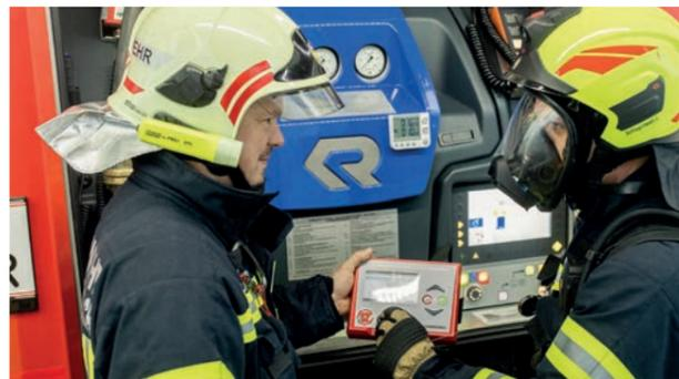
Der Atemschutzträger meldet sich über einen Datenträgerchip an und die Checkbox übernimmt die Überwachung
