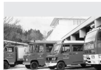
**1 RLF-A** (Rüstlöschfahrzeug mit Allrad) mit 2000 l Wasser, 200 l Schaum, B-C-H Schläuche, 1200 l/min Wasserwerfer, Bergegeräte, 20 kVA-Notstromaggregat, Werkzeuge, Atemschutz, usw.
