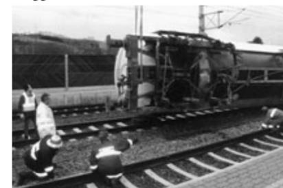
Sicht- und Messkontrollen beim Anheben der Kesselwaggons durch zwei Kräne der ÖBB.
